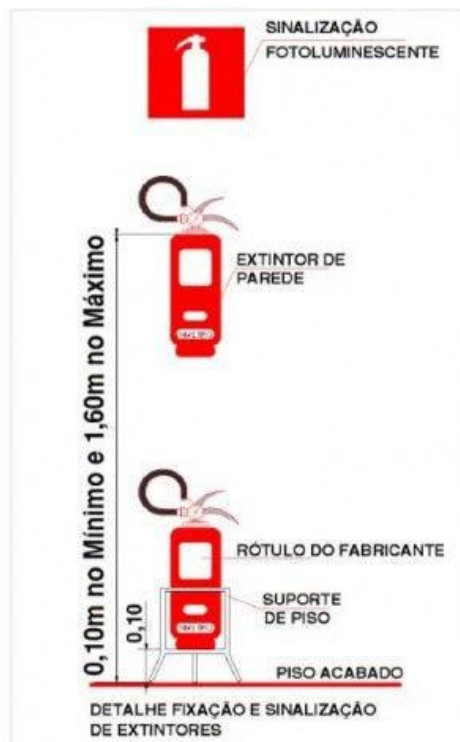
Fig. 02 – Detalhes fixação extintores
